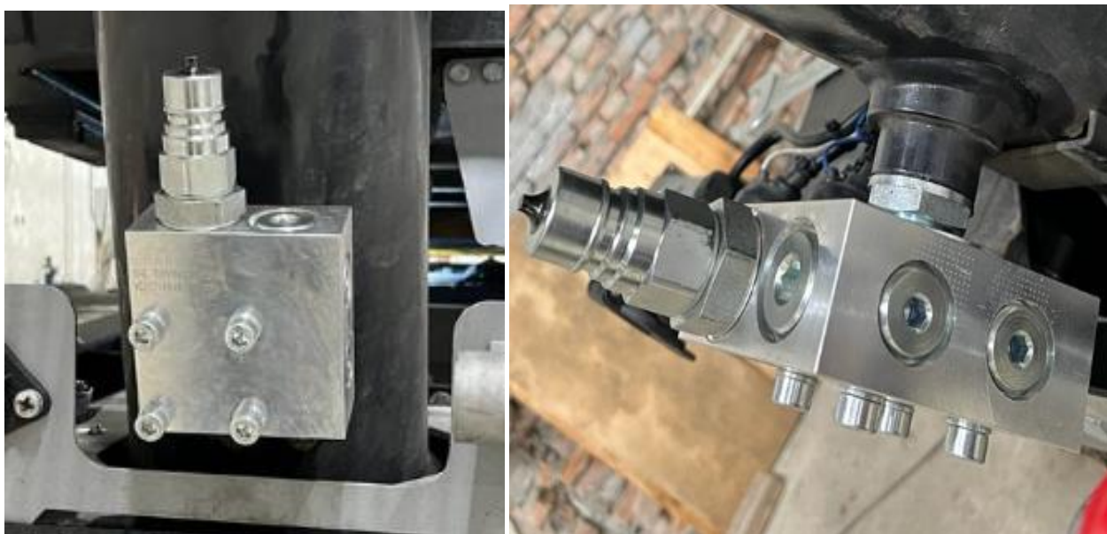
Рис. 1.16 Блокирующий клапан гидроцилиндра
